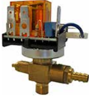
9V26933 PRESSOSTATO XP700+C110P 0,5-1,5 BAR G1/4 230VAC CON VALVOLA SICUREZZA 1,8 BAR PRESSURE SWITCH XP700+C110P 0,5-1,5 BAR G1/4 230VAC W/SAFETY VALVE 1,8 BAR
